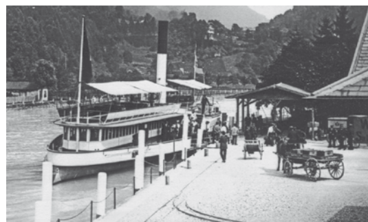
Le vapeur OBERLAND , construit en 1870 et ayant navigué sur le lac de Brienz jusqu'en 1925, en station à Interlaken Ost. Ce bateau avait la particularité d'avoir une proue et une poupe symétrique; il disposait de deux gouvernails, placés de part et d'autre de la cheminée, pour la navigation dans le canal de l'Aar. Collection: Peter Gondolf, Bergkamen (DE).
