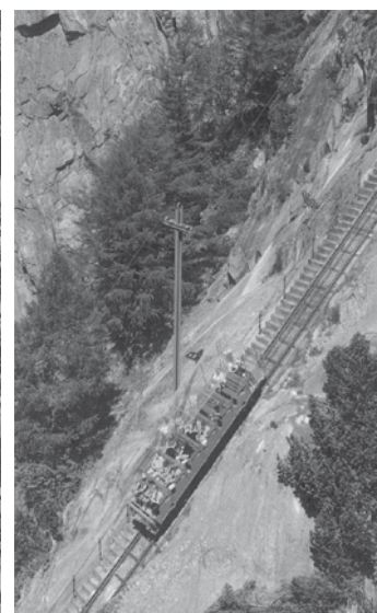
Le spectaculaire funiculaire du Gelmer n'a qu'une voiture et il circule sur une déclivité de 106 %. Installation de service des Forces motrices d'Oberhasli, elle est maintenant ouverte au tourisme estival. Photo KWO
