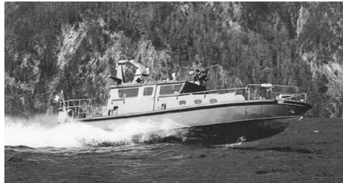
14 nouveaux canots patrouilleurs P-16 remplaceront leurs aînés, les P-80. La fabrication des canots aura lieu en Finlande entre 2018 et 2021 (projet contenu dans le programme d'armement 2016 pour un montant de 49 millions de CHF). Voici une vue du prototype; capacité de transport: 15 personnes, vitesse maximale: 65 km/h.
